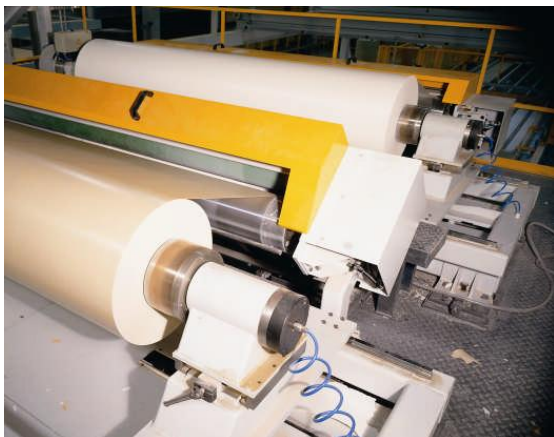
Abb.5: Kalandrierwerk für dekorative Melaminharzfilme
