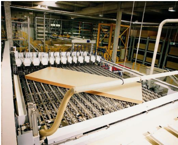
Abb.6: Aufteilanlage mit Drehstation für Kopfschnitte (HOLZMA I)
